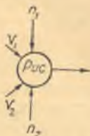
Рис. 20. Модификация вентиль с раздельными входами и общим выходом.
