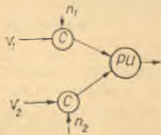
Рис. 20. Модификация вентиль с раздельными входами и общим выходом.
