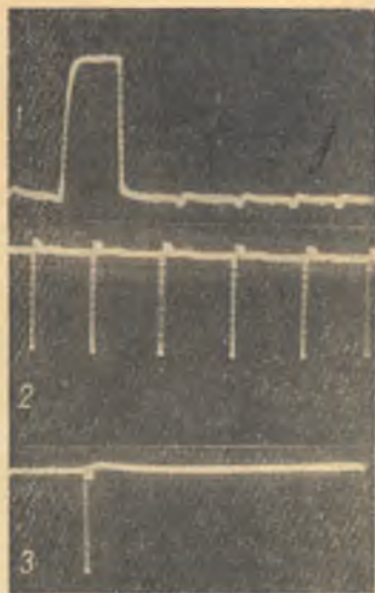
Рис. 21. Осциллограммы сигналов на входах и выходе многовходового вентиля:
