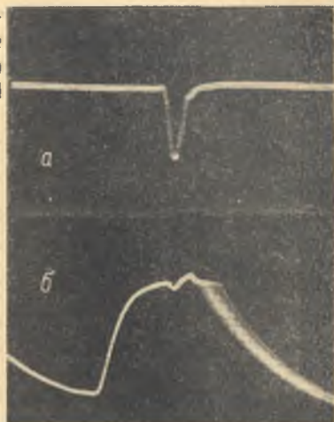
Рис. 48. Осциллограммы сформированных импульсов воспроизведения (а) и потенциала стробирования (б).
